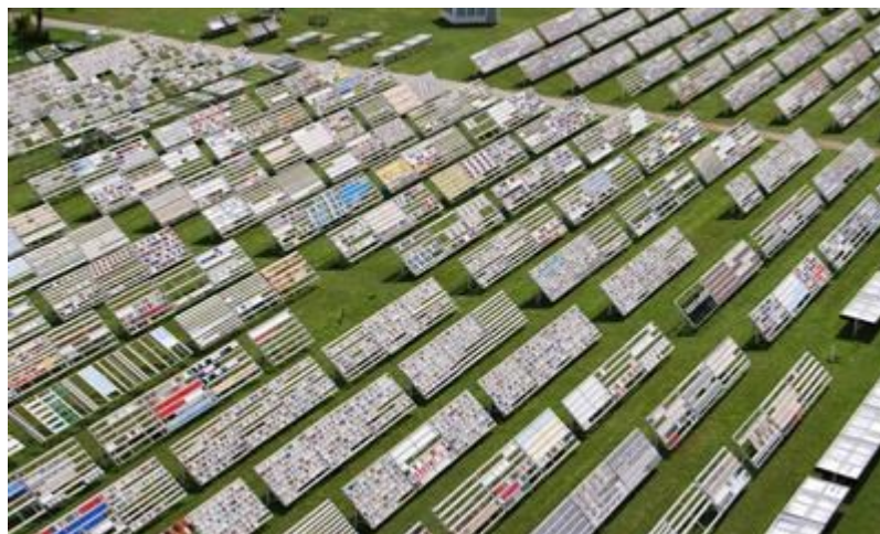
Obr. 2 Rozmístění vzorků určených k testování povětrnostních vlivů [30]
