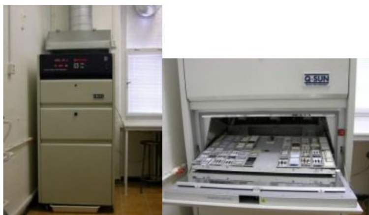
Obr. 5 Veterometr Q-Sun (vlevo) a komora se vzorky (vpravo) (upraveno z [49])
