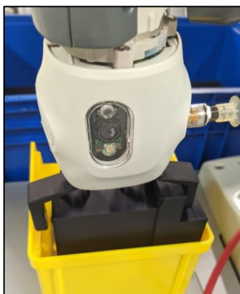
Obrázek 38: Kamera zasazená do koncového efektoru
