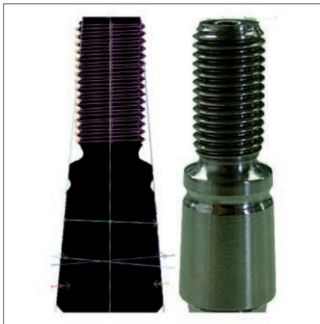
Obrázek 28: Měření závitu a kužele na kulovém čepu [14]
