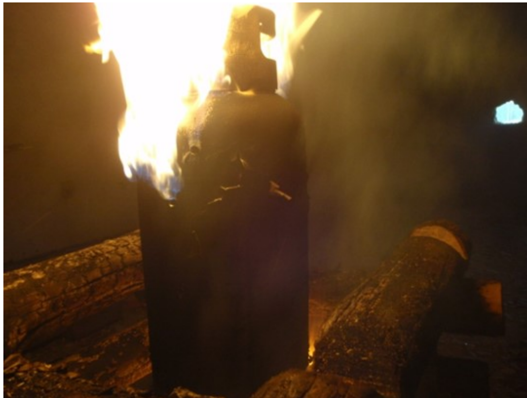
Obrázek 9 - Hořící propan-butanová prostřelená tlaková lahev se stěnou
