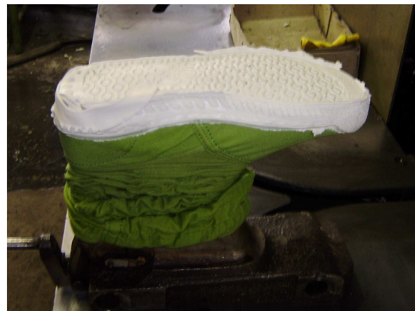
Obr. č. 11 Chystanie topánky na lisovanie a zapravovanie.
