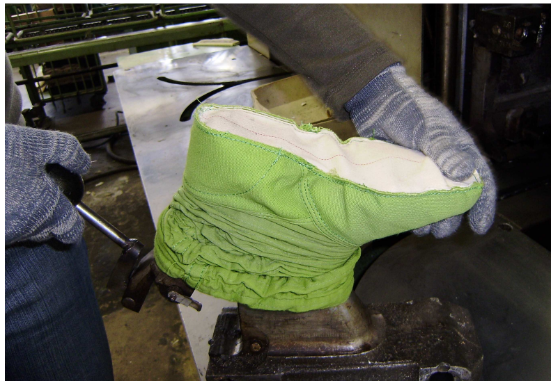
Obr. č .8 Napínanie zvršku obuvi na kovovú nôžku.
