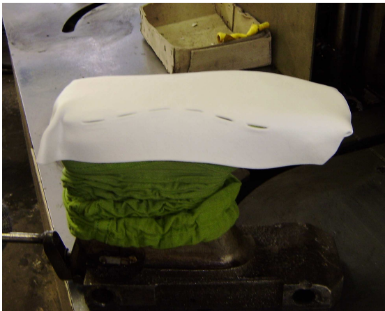
Obr. č. 11 Chystanie topánky na lisovanie a zapravovanie.
