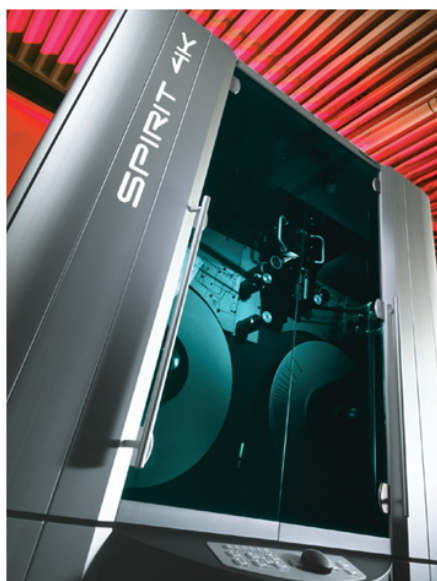
6. Filmový skener Spirit z roku 2003 společnosti Thomson s rozlišením 4K a rychlostí skenování 7,5 fps
