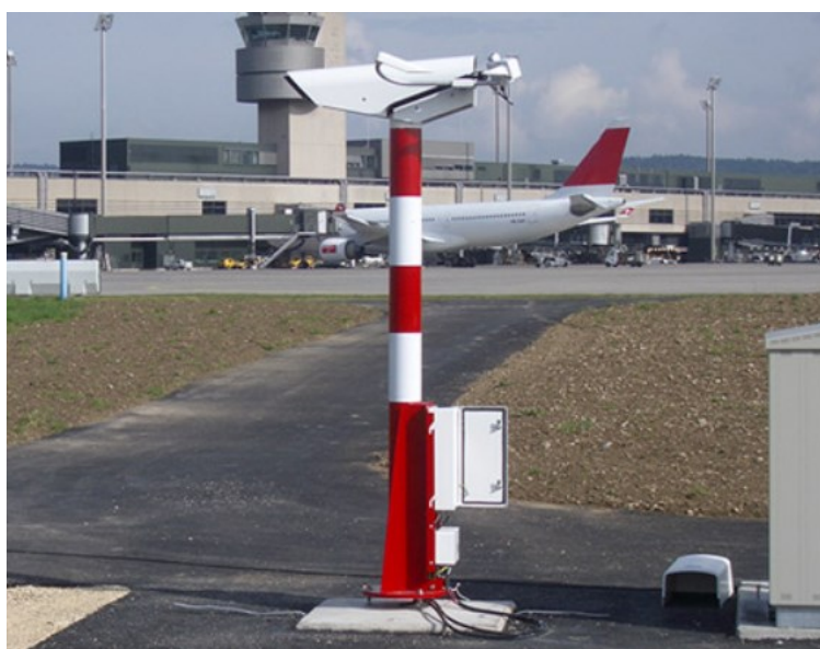
Obrázek 6 Letištní meteostanice od firmy Vaisala [15]
