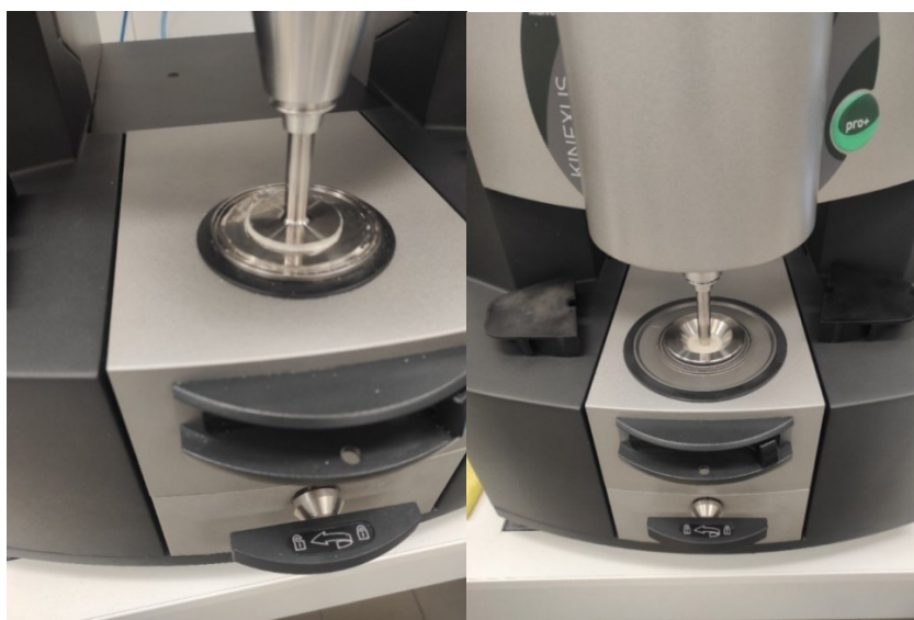
Obr. 19: Reometr Kinexus: nalevo geometrie deska-deska a vpravo geometrie válec-válec
