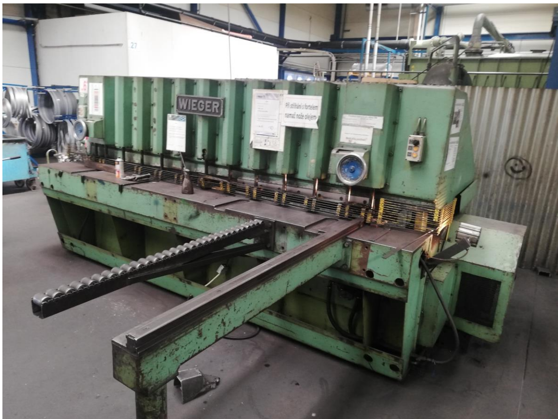
Obrázok 7 - Tabuľové nožnice Wieger používané vo vybranej firme (vlastná fotografia)
