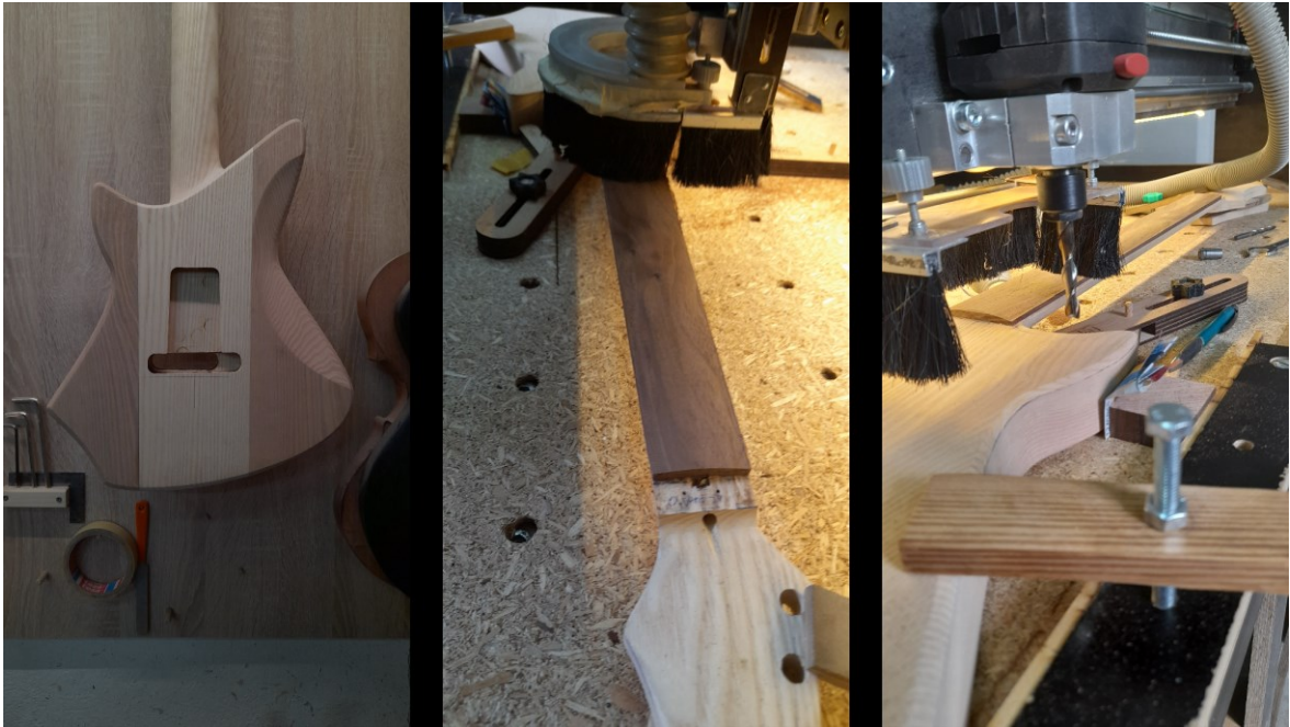
Obrázok 71 Vyhĺbený priestor pre pružiny a tremolo (vľavo), frézovanie rádiusu na hmatníku gitary (vpravo)
