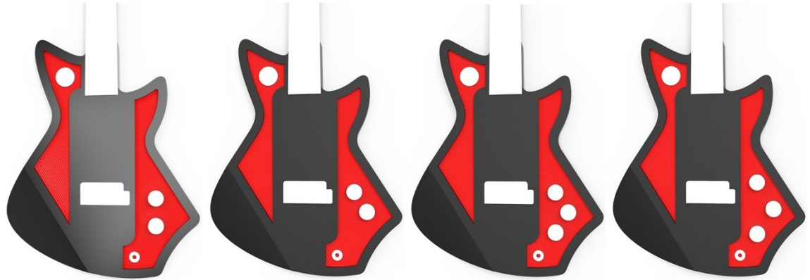
Obrázok 31 Variantné riešenie umiestnenia potenciometrov
