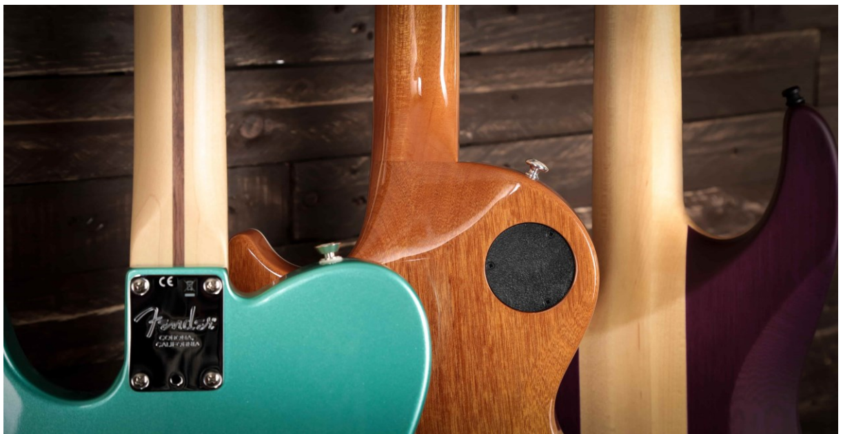
Obrázok 5 Typy spojení krku a tela - vľavo skrutkovaný krk, v strede lepený krk, vpravo krk prechádzajúci celým telom (VAN WYNGAARDT, 2019)
