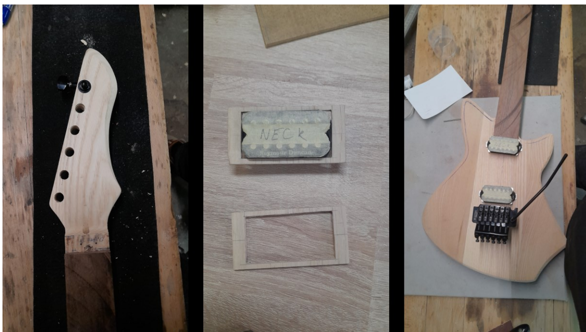
Obrázok 70 Rozmiesťovanie ladiacich mechaník, snímačov, tremola a vyrobených rámykov z dreva, ktoré slúžia na uchytanie snímačov
