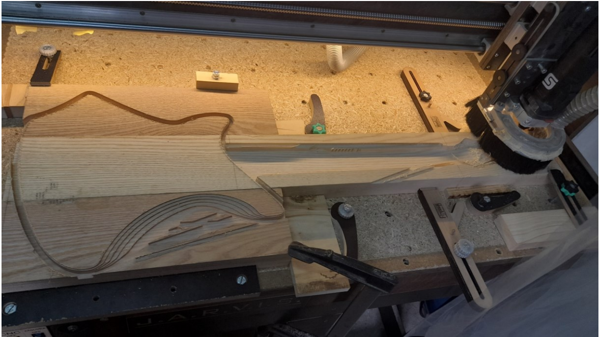
Obrázok 67 Frézovanie zadnej strany
