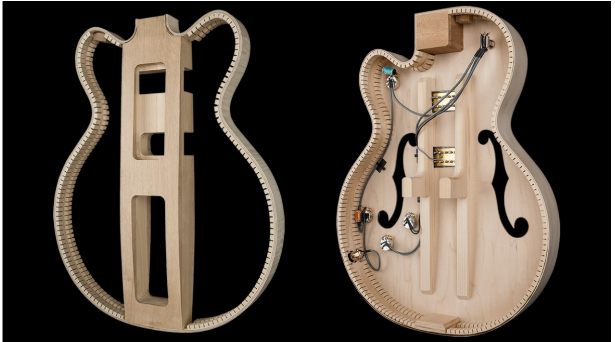
Obrázok 4 Typy tela gitary – vľavo polo-akustická gitara s centrálnym blokom, vpravo gitara s dutým telom (Gretsch)
