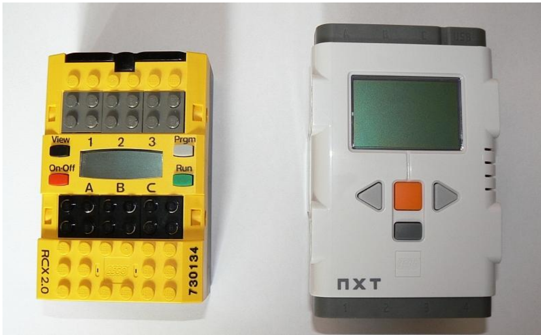
Obrázek 7: Porovnání jednotky RCX a NXT
