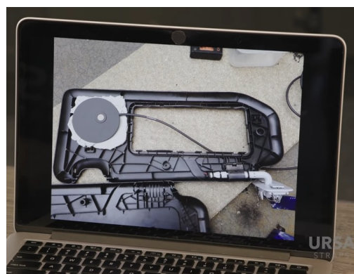
Obrázek 13: Boundary mikrofón zabudovaný ve stínítku
