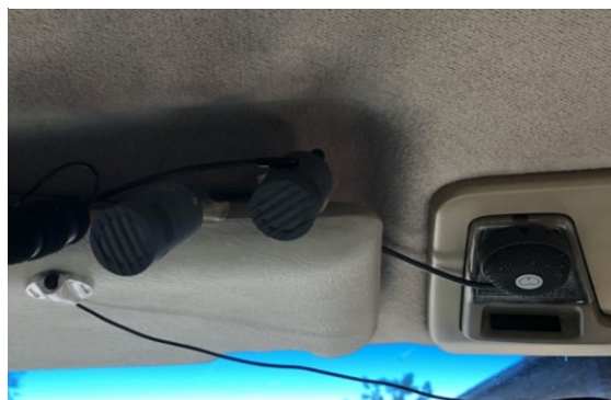
Obrázek 11: Použití Sanken CUB 01 v automobilu
