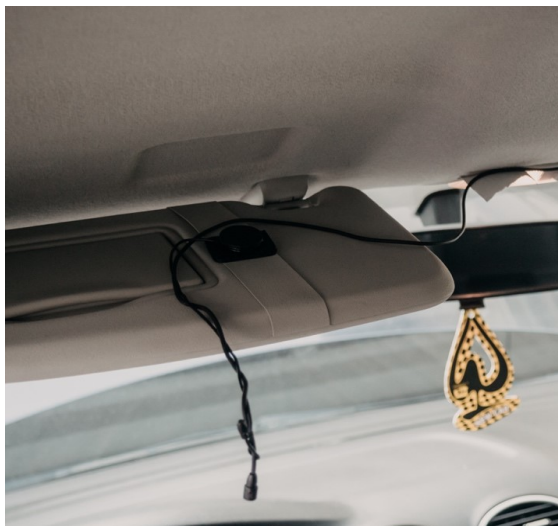
Obrázek 34: Využití systému WireRig za stínítkem
