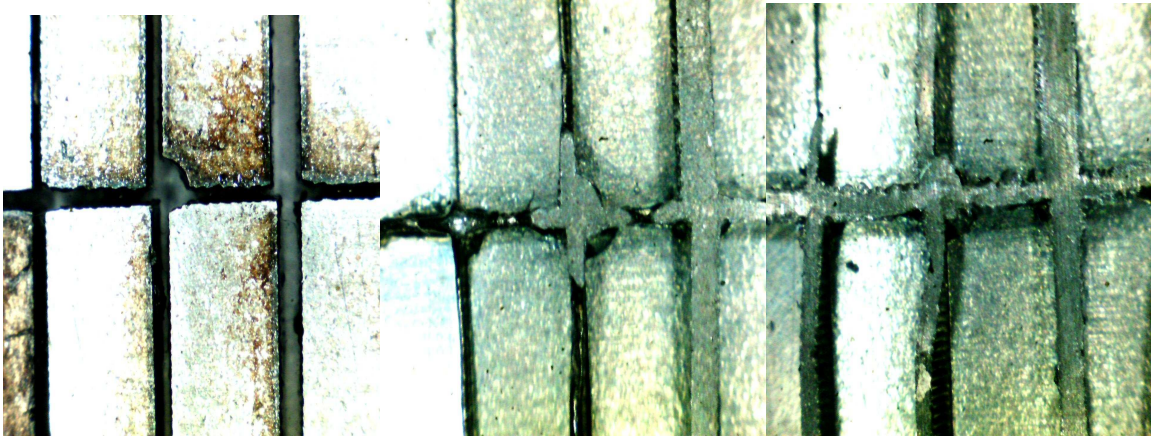
Obr. 61. Přímé dráhy, svislé - nalevo deska obrobená laserem, uprostřed první vylisovaný vzorek, napravo druhý vylisovaný vzorek
