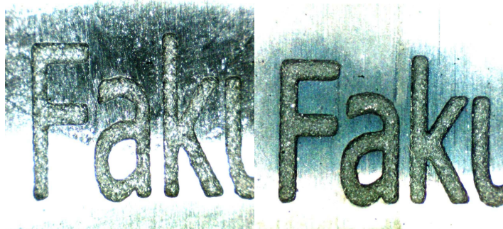
Obr. 55. Text - nalevo chemicky obrobena deska, napravo vylisovaný vzorek z pryže
