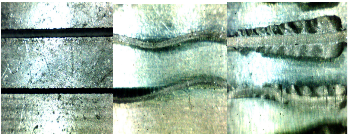
Obr. 62. Přímé dráhy, vodorovné - nalevo deska obrobená laserem, uprostřed první vylisovaný vzorek, napravo druhý vylisovaný vzorek
