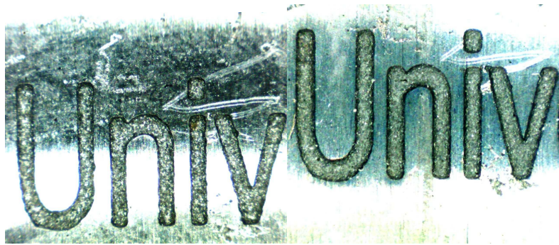
Obr. 53. Text - nalevo chemicky obrobena deska, napravo vylisovaný vzorek z pryže
