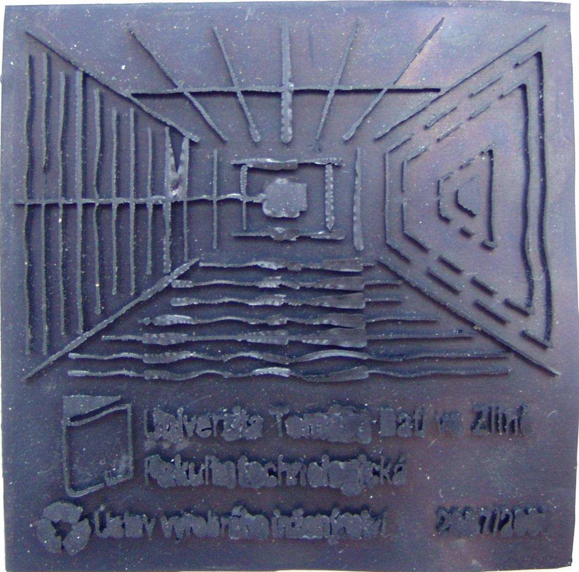
Obr. 52. Vylisovaný pryžový vzorek deskou obrobenu laserem
