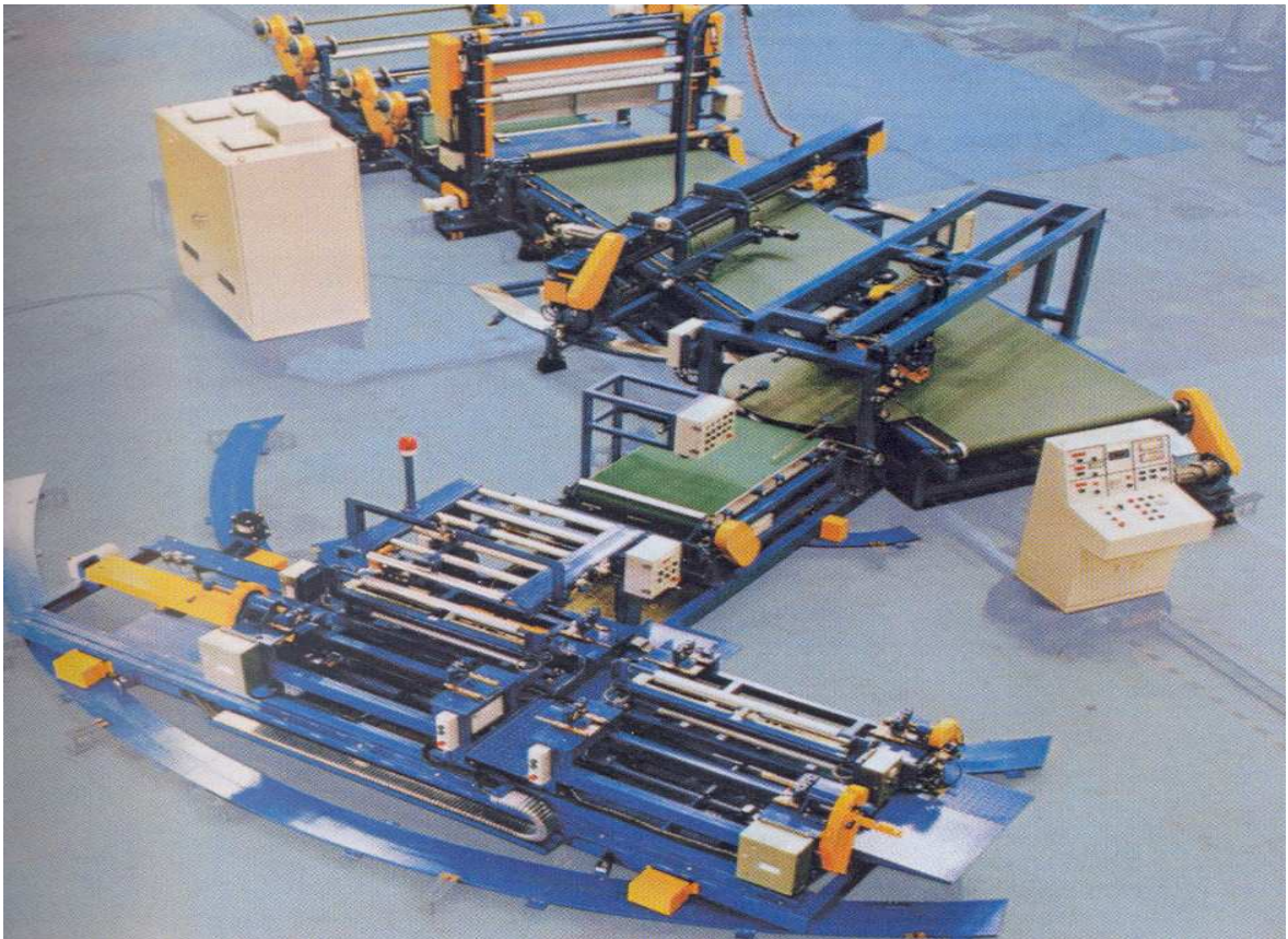
Obr. 6. Linka na stříhání pogumovaného textilu
