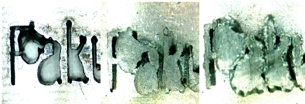
Obr. 56. Text - nalevo deska obrobená laserem, uprostřed první vylisovaný vzorek, napravo druhý vylisovaný vzorek
