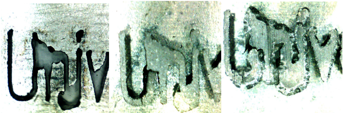
Obr. 54. Text - nalevo deska obrobena laserem, uprostřed první vylisovaný vzorek, napravo druhý vylisovaný vzorek
