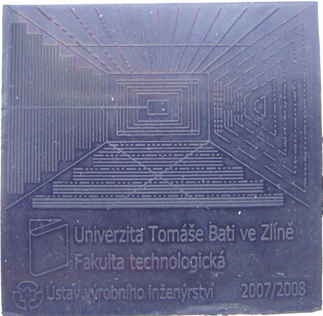
Obr. 50. Vylisovaný pryžový vzorek deskou chemicky obrobenou
