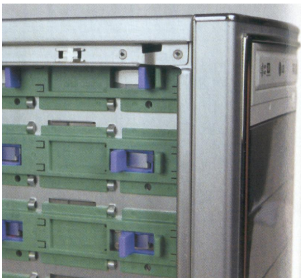
Obr. 22. Plastový zajišťující systém mechanik
