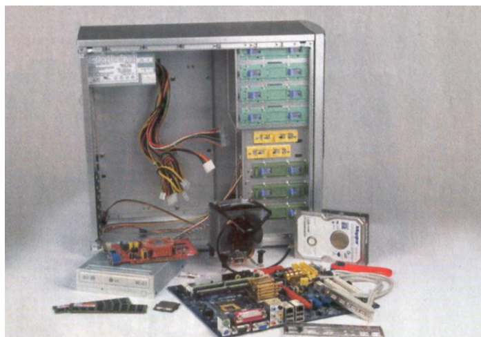
Obr. 1. Počítačová skříň včetně napájecího zdroje a další komponenty
