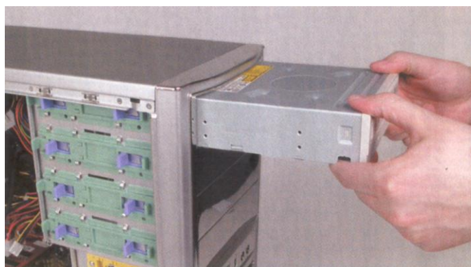
Obr. 21. Instalace optických mechanik
