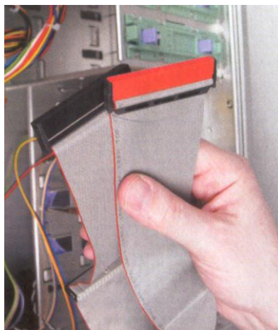
Obr. 23. 80 žilový kabel IDE
