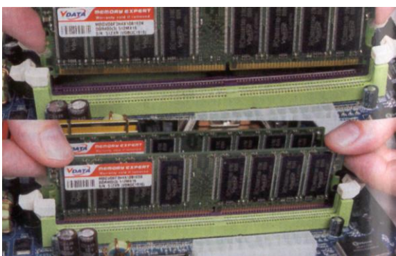
Obr. 9. Instalace paměťových modulů do slotů na základní desce
