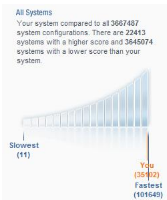
Obr. 32. Celkový grafický výkon sestaveného počítače v programu 3D Mark 03 verze 3.6.0 pod OS MS Windows Vista Business x64 ve srovnání s ostatními testovanými počítači.
