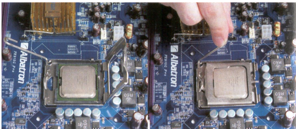
Obr. 4. Procesor v patici LGA 775 a jeho zajištění pomocí páčky
