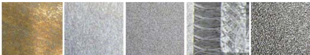
Obr. 28. Povrchy desek (leštěný, broušený, jemný dezén, frézovaný, hrubý dezén)
