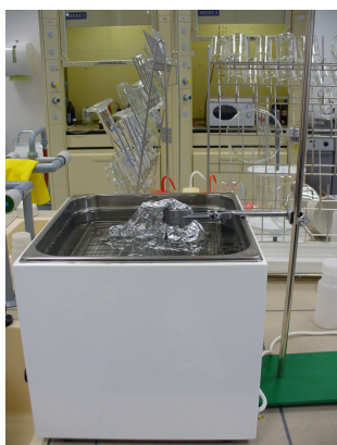
Obrázek 13 Rozpouštění PMPSi v THF v ultrazvukové lázni.
