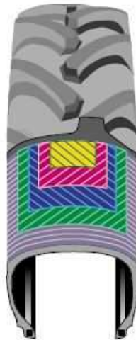
Obr. 4 Konstrukce radiální zemědělské pneumatiky
