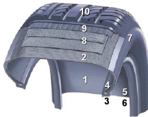
Obr. 5 Základní prvky struktury pláště pneumatiky
