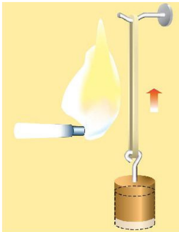
Obr. 6 – Princíp Gough – Joulovho efektu
