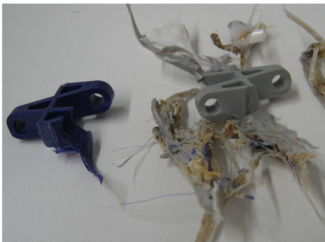
Obr.16. Roztavené vzorky PMA poškodily okolní vzorky
