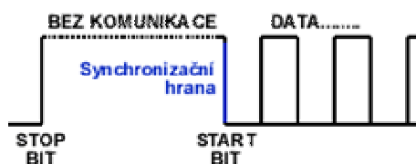
Obr. 3. Synchronizace sestupnou hranou (7)
