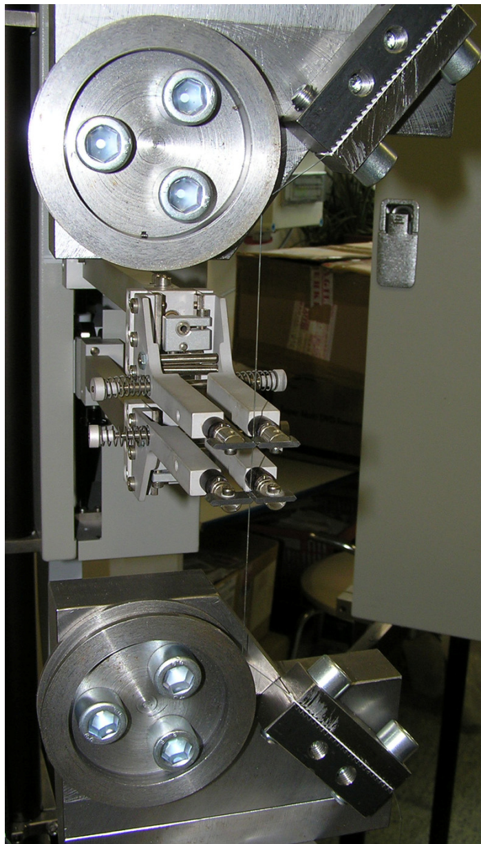
Obr. 27. Čelisti pro zkoušku tahem drátů a kordů
